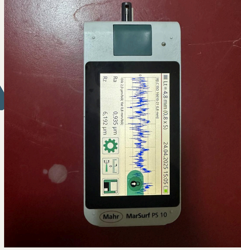
Elde edilen seramiklerin solüsyonlarda bekletilmeden önce profilometre cihazıyla pürüzlülüklerinin ölçülmesi
