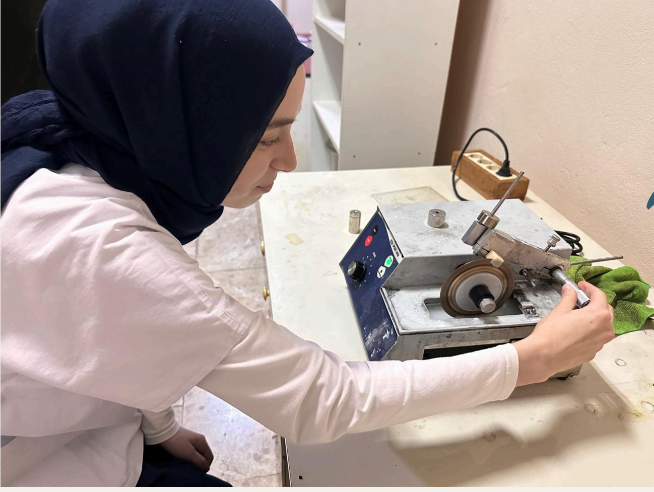
Çalışmada kullanılan seramikler 1.5 mm kalınlıkta KTÜ Makine Mühendisliğinde izomet cihazı ile kesilmiştir.
