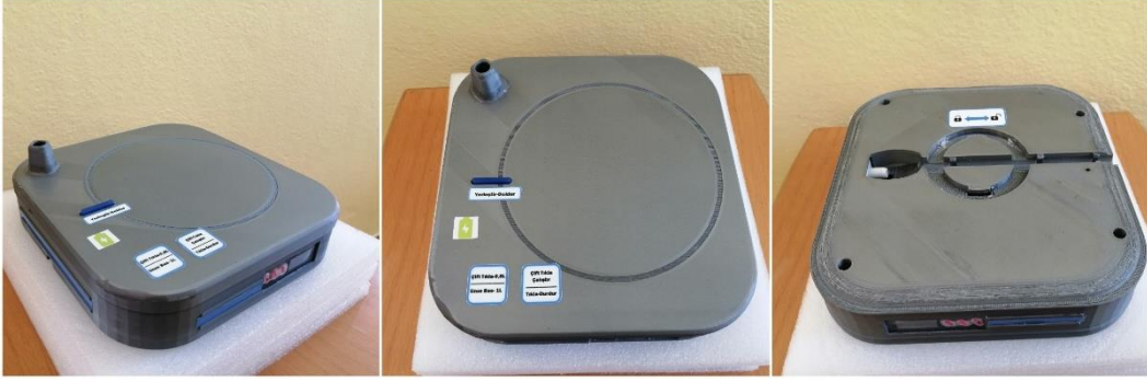
Şekil 42. Pompa gövdesine PVC etiketlerin yapıştırılmış hali
