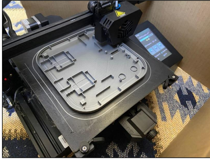
Şekil 30. Damacana pompası gövdesi üst kapağının üretimi
