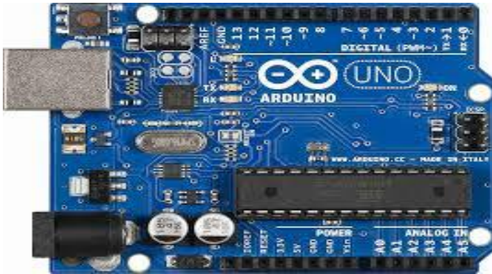
Şekil 1-1: Merkezi Kontrol Ünitesi-Arduino UNO R3
