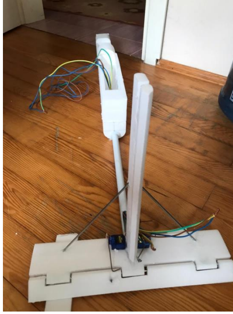
ŞEKİL 2.11. Kuyruk - Gövde Montajı
