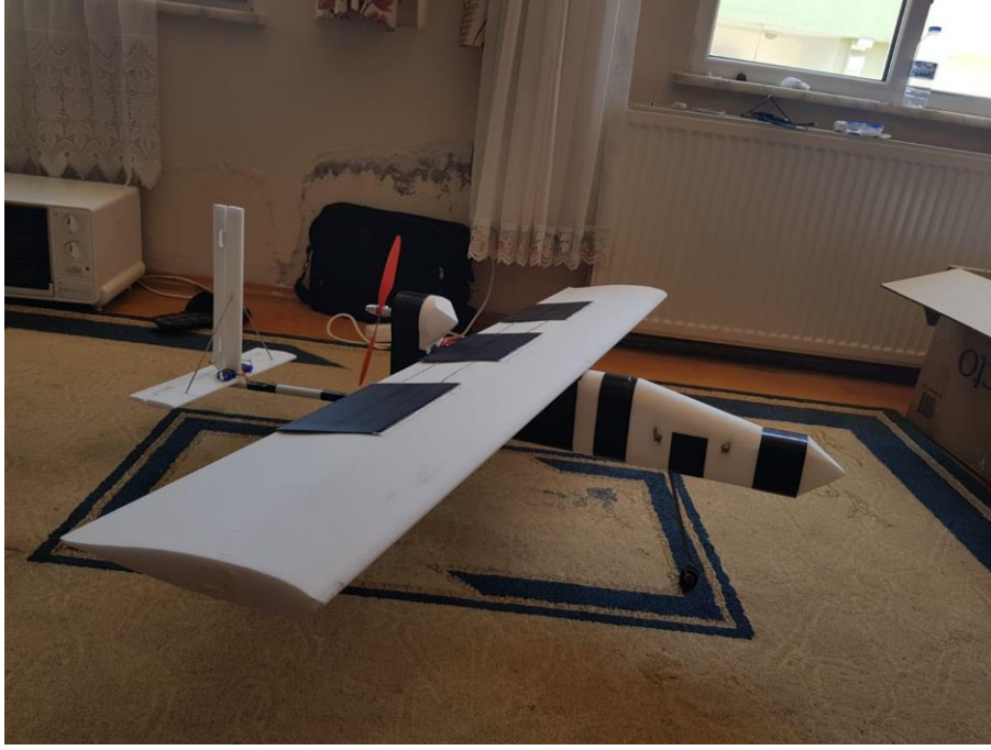
ŞEKİL 2.16. Montaj Son Durumu
