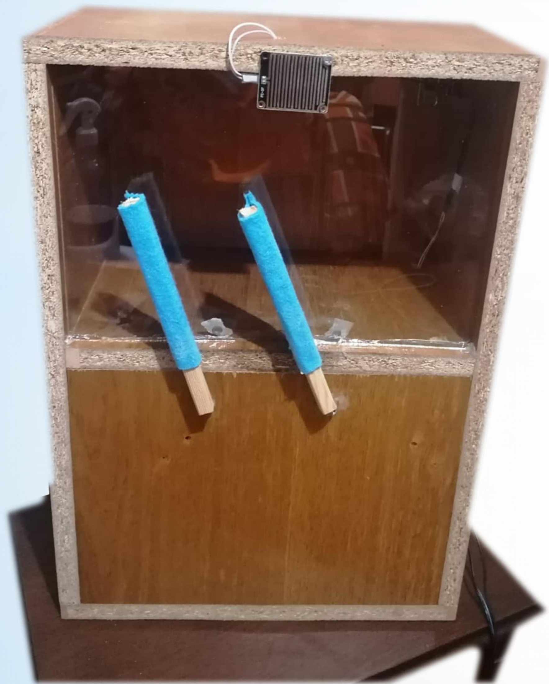
Şekil 4. Silecek mekanizmasının tamamlanmış hali (Prototip)
