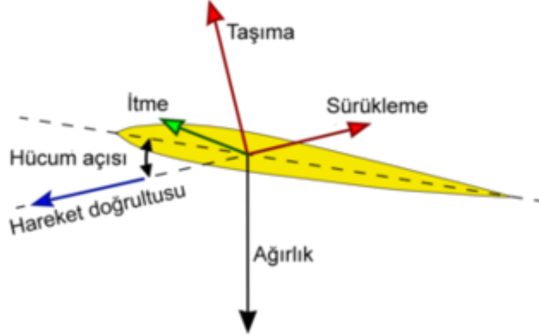
Şekil 25. Pervanede Oluşan Kuvvetler
