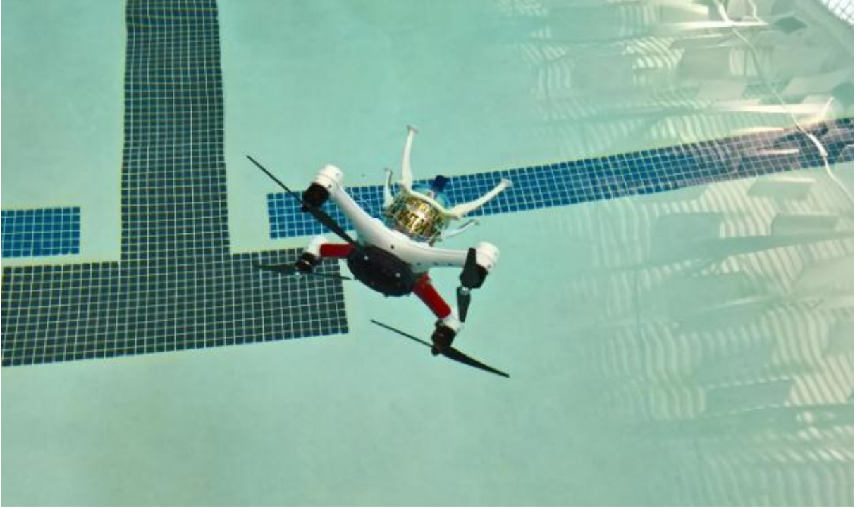
Şekil 17. Ookland Üniversitesi Hava ve Su Altı Ortamlarında Çalışan Looncopter
