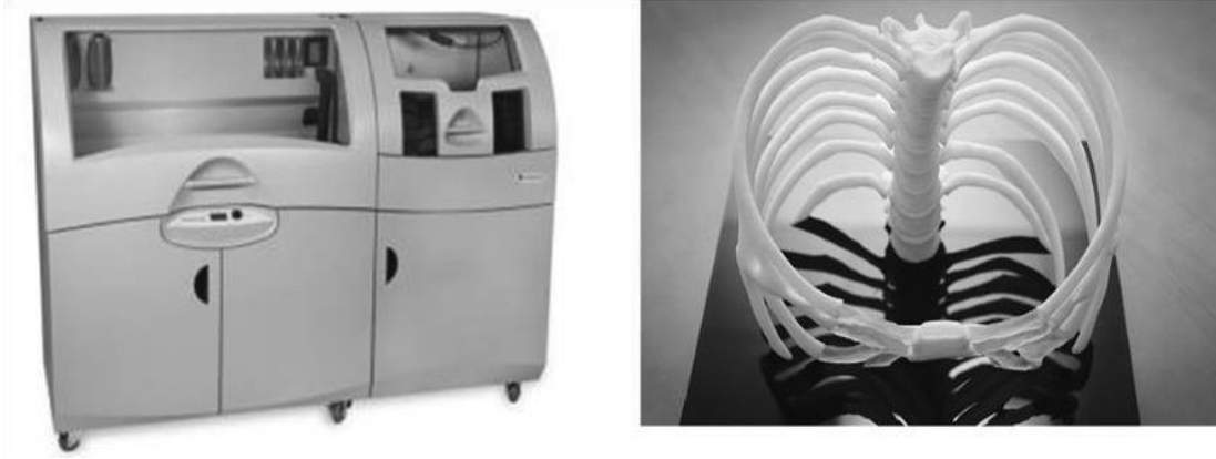
Şekil-13: Seciçi lazer sinterleme (SIS) yöntemi ile çalışan üç boyutlu profesyonel yazıcı ve SIS yöntemi ile üretilmiş tıbbi model.
