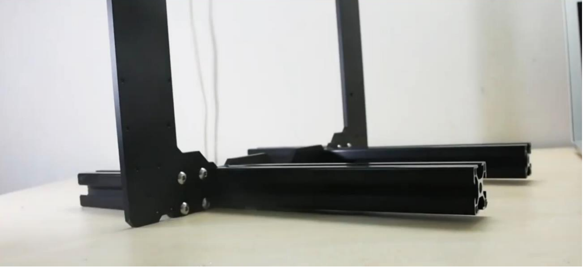
Şekil 36; Ana gövdeyi oluşturmak için sigma profil ve saç levhaları bağlantı elemanları kullanılarak montajın gerçekleştirilir.
