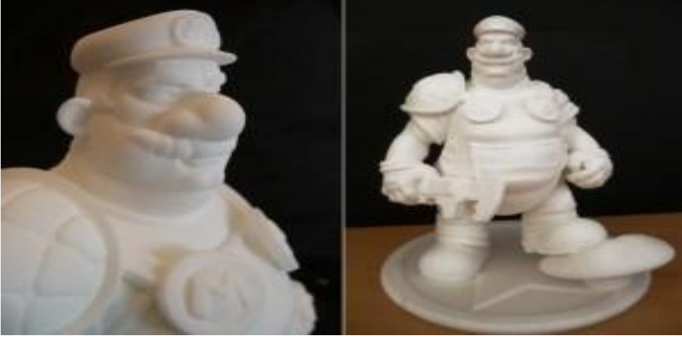
Şekil-19: “RepRap”la basılmış örnek parça
