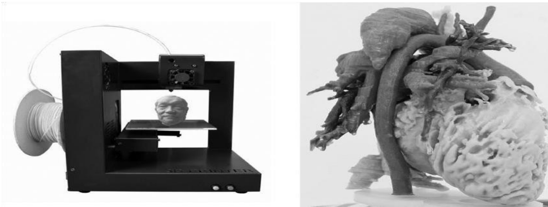
Şekil-14: Bileşimli yığma yöntemi (FDM) ile Pla filament kullanarak baskı yapan bir masaüstü üç boyutlu yazıcı ve FDM yöntemi kullanılarak üretilmiş kalp maketi.
