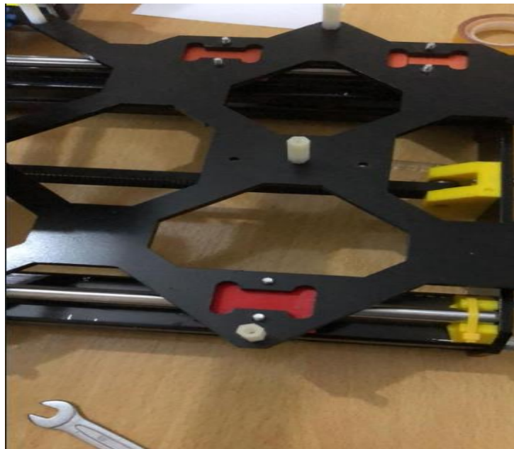
Şekil 94 ; Lineer rulmanın krom mile takılması
