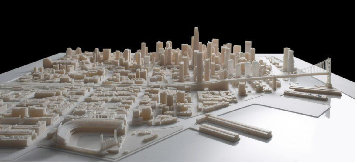
Şekil-16: Üç boyutlu yazıcı ile üretilmiş mimari tasarım
