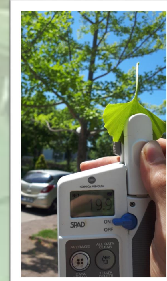
Klorofil metre cihazı (Minolta SPAD-502) ile örnek ölçüm
